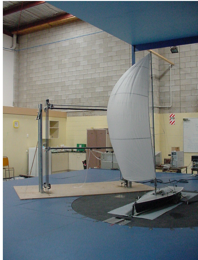
Figura 84: il modello della barca Volvo Ocean Race usato per gli esperimenti nella galleria del vento di Auckland (foto di Natascia Erriu)
