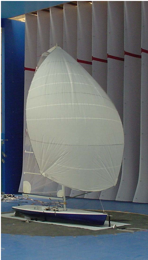
Figura 84: il modello della barca Volvo Ocean Race usato per gli esperimenti nella galleria del vento di Auckland (foto di Natascia Erriu)
