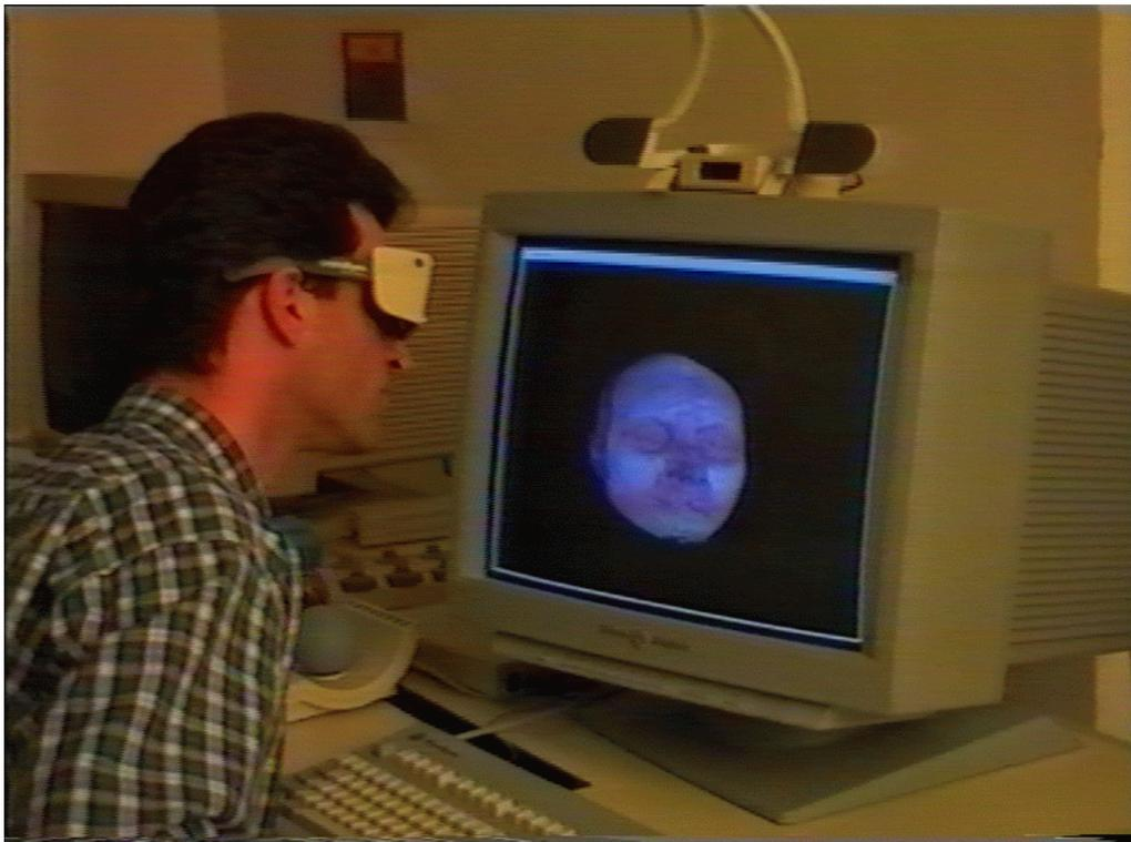
**Figura 1: Tracciamento della posizione dell'osservatore durante la visualizzazione stereoscopica di un volume ricostruito da dati CT.**
